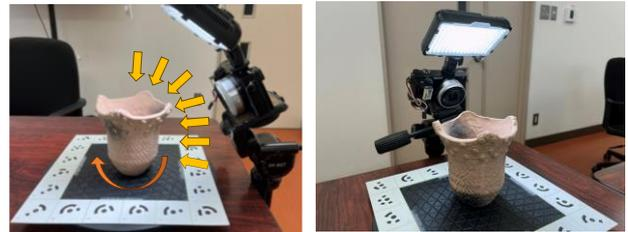
撮影は回転台・カメラ・三脚・照明を用意し、撮影方向を変えながら行う。計測対象から10cmの近接撮影を行った場合、1画素は0.002cmの分解能となるため非常に細かな表示ができる。ソフトウェア上で解析した結果、計測誤差0.253mmであった。
