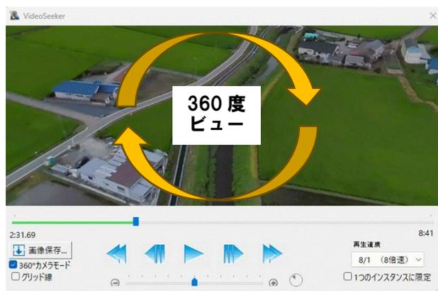
動画から写真点群測量を行う際は、動画 MP4 ファイルからラップ率を考慮し一定間隔でキャプチャを行い画像ファイルとして保存する必要がある。キャプチャはフレームレート数から行うため、動画のフレームレートと撮影ラップ率を考慮し撮影計画を行う必要がある。
